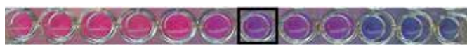
Billede 3: MIC bestemmes ud fra den første brønd med en mindre farveintensitet end den positive kontrolbrønd. Den sorte firkant angiver, hvor MIC bør fastsættes.
