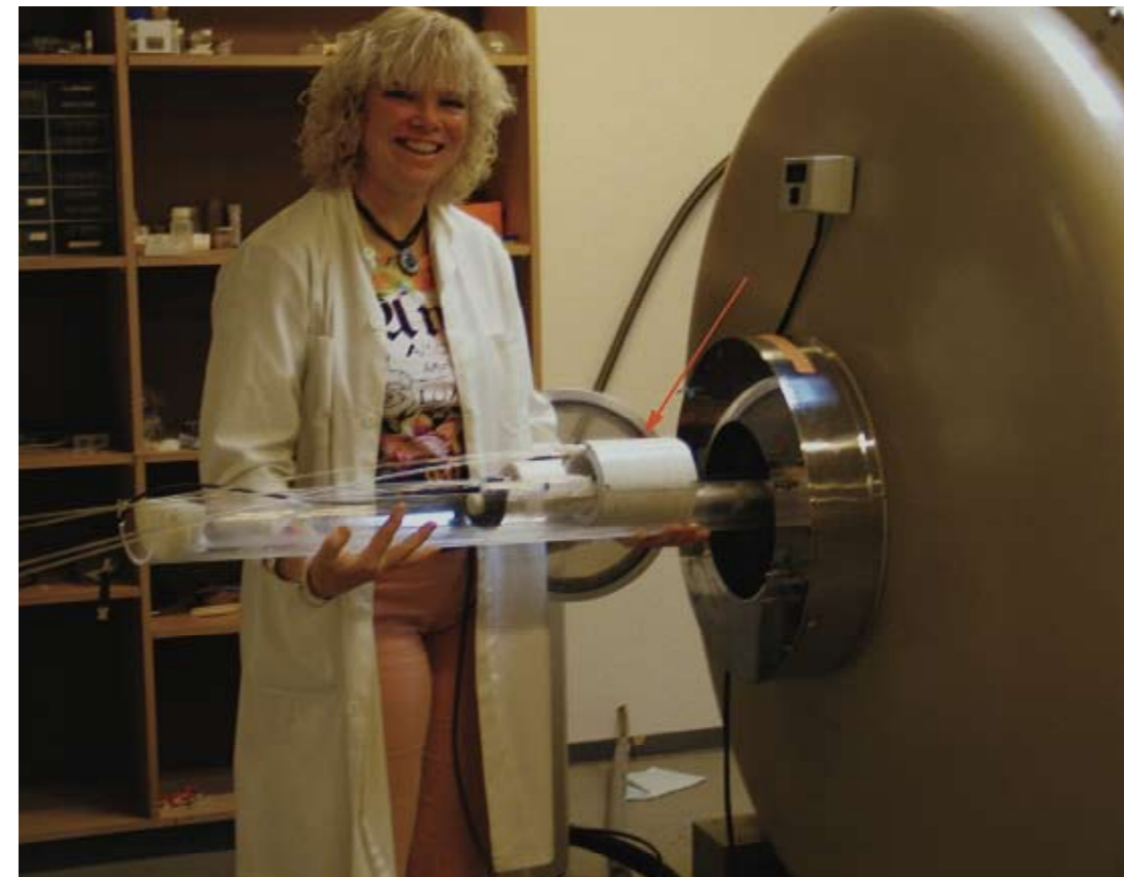
Figur 1: 4.7 tesla Magnetisk Resonans skanner, som bliver brugt til skanning af mindre forsøgsdyr. Den røde pil viser et eksempel på en hjemmebygget spole, som bruges til at optage MR billeder og spektroskopi. Spolen sender og modtager de radiosignaler, som efterfølgende behandles i computersystemet.
