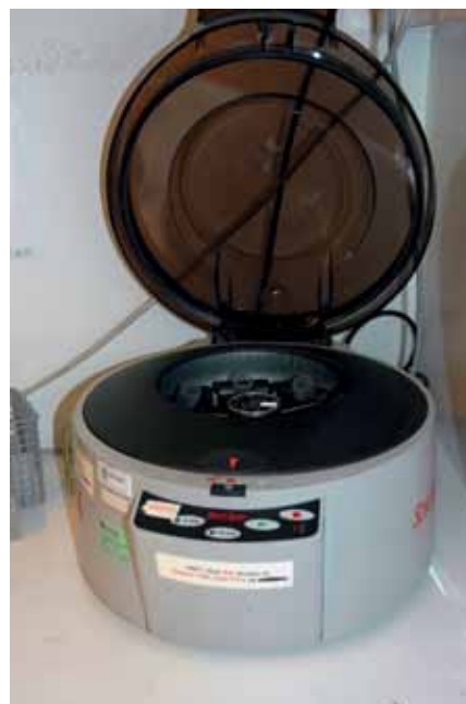
Hurtigcentrifuge StatSpin Express 4 brukes kun til INR, APTT, D-dimer, Fibrinogen og AT III.
