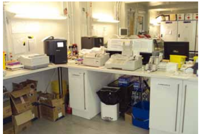
På felthospitalet er der både udstyr og backup-udstyr. Her backuppen med tørstofkemi Vitros og Coulteren, som bruges til hæmatologi
