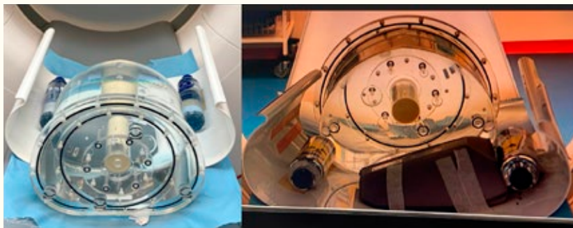
Billede 2 Fantomopstillingen med NEMA-fantom, der skulle symbolisere torso, og to tilhørende vandflasker, der skulle symbolisere arme.
