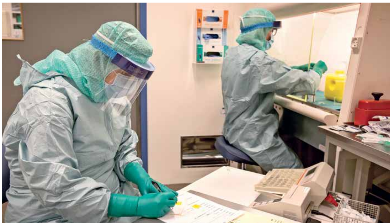
Bioanalytikerne trækker det radioaktive stof op i et specialindrettet lokale i en labbænk, hvor bioanalytikerens er skærmet med en blyglasplade og ekstra ventilation.
