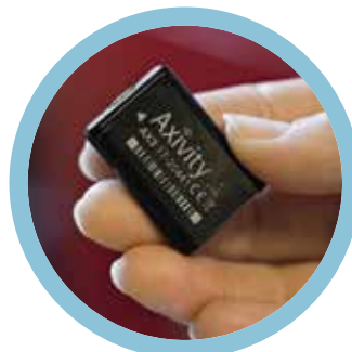
Axivity er en lille bevægelsesmåler, der sidder på lår og lænd i 7 dage. Den giver et 3 dimensionelt billede af alle bevægelser.
