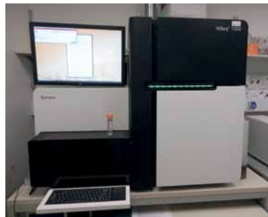
FIG 1. HiSeq 1500, flowcellen ses i røret med orange låg.
