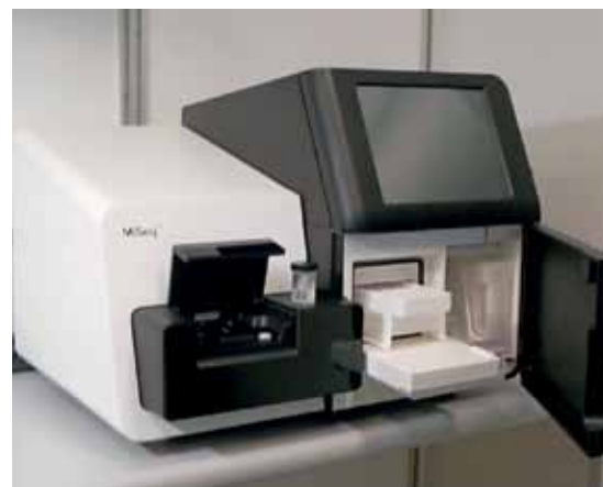
FIG 2. MiSeq, flowcellen med 1 lane ses i det lille rør med sort låg.
